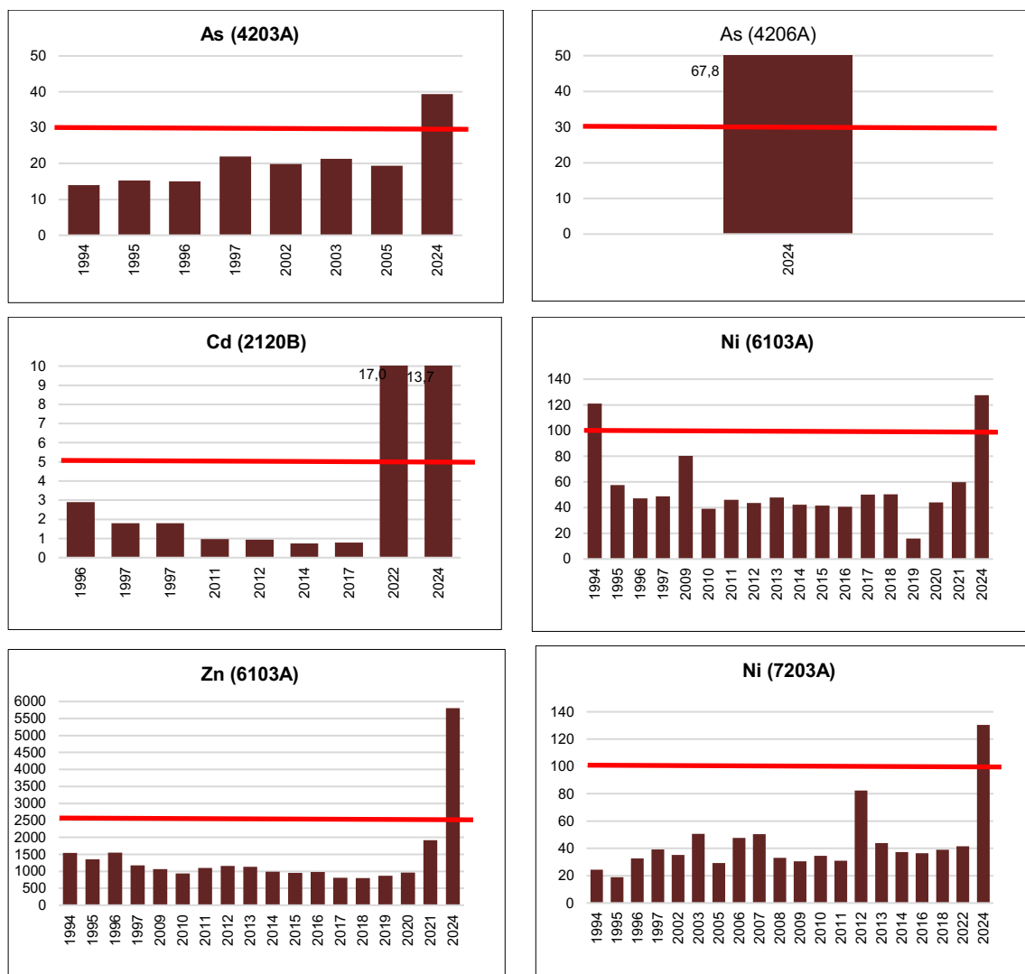
Obrázek 33 Vývoj obsahu rizikových prvků v kalech ČOV, které v roce 2024 překročily limitní hodnotu danou vyhláškou č. 273/2021 Sb. ( \text{mg.kg}^{-1} ). Limitní hodnota je označena červenou linií
