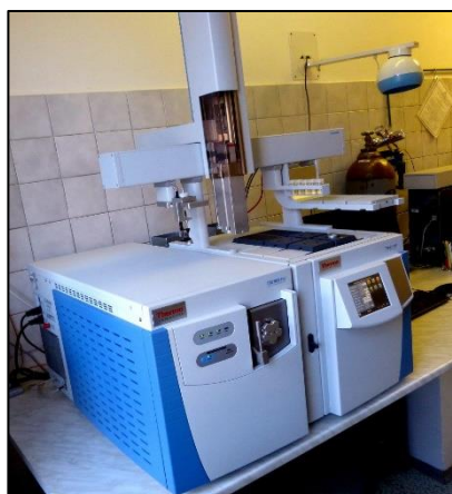
Obrázek č. 10: Plynový chromatograf s hmotnostním detektorem typu trojitého kvadrupolu. Vedle pesticidních analýz se využívá i při stanoveních perzistentních organických kontaminantů. Byl zakoupen z prostředků NAP.
