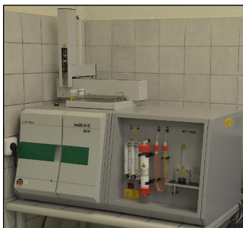
Obrázek č. 11: Analyzátor C a N v roztoku s modulem pro C v pevných vzorcích půdy.
