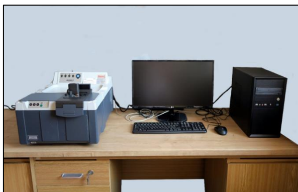
Obrázek č. 12: Spektrometr NIRS. Používá se ke stanovení glomalinu a Cox v půdách. Také slouží ke stanovení oleje a dusíkatých látek v semenech slunečnice a sóji.
