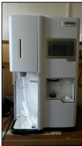
Obrázek č. 15: Automatická destilační a titrační jednotka se používá pro stanovení dusíku ve vzorcích hnojiv a krmiv.
